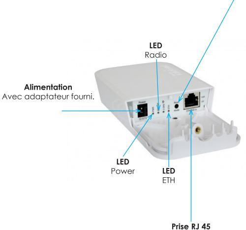
Accès au réseau Digitear. Il est conseillé d'utiliser un câble RJ45 CAT5E U/UTP. Possibilité d'alimenter l'antenne par PoE (802.3 af/at).
